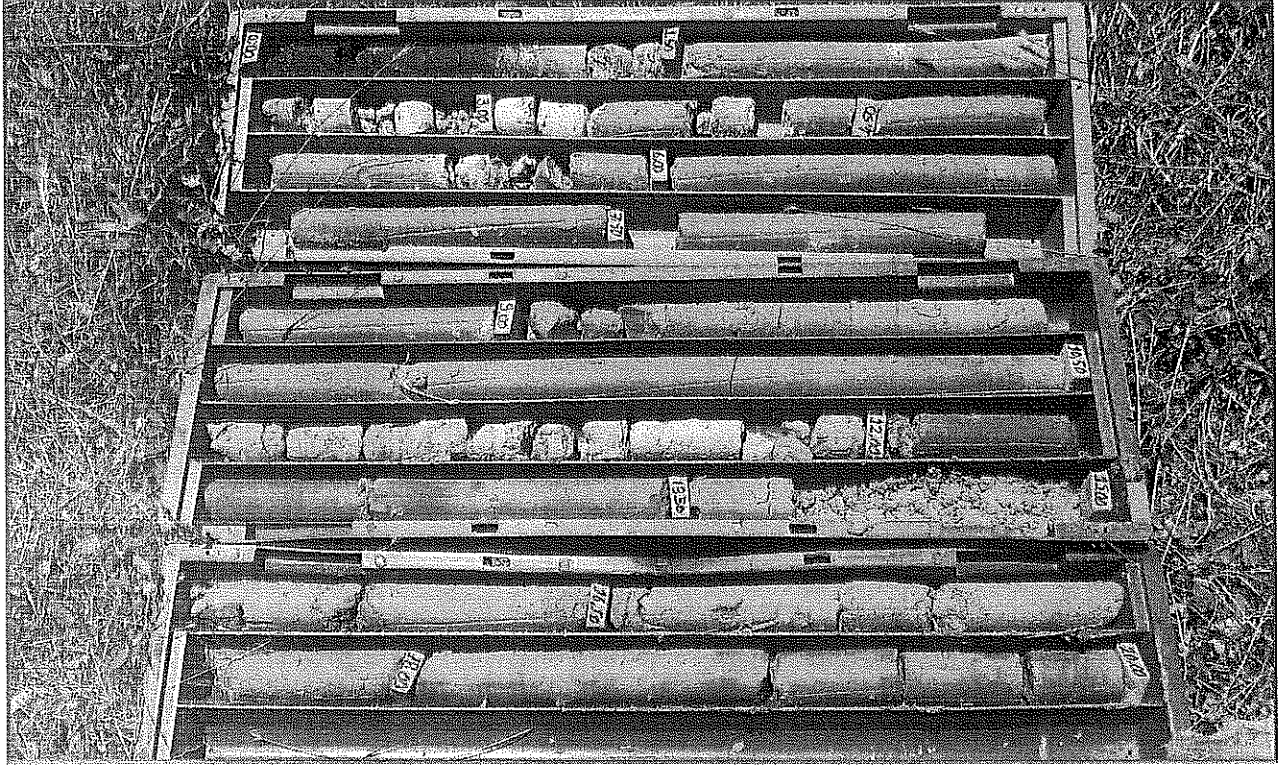
Görüntü 2.2.6: İnceleme alanında yapılan SK1 nolu sondaja ait karot sandığı görüntüsü
